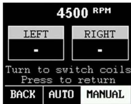
**MANUAL** anwählen und durch Drehen um eine Raststellung nach links die linke Zündspule abschalten.
