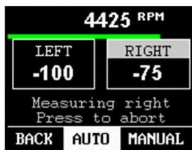
Der Test lässt sich durch Drücken des Drehwahlschalters abbrechen, jedoch dauert der Test nur ca. 10 Sekunden.
