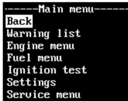
Das Hauptmenü **Main Menu** bietet alle Funktionen des Bildschirmmenüs und zusätzlich noch das **Engine menu**, **Settings** und das **Service menu**. Durch Drehen und anschließendem Drücken des Drehwahlschalters wird eine der angebotenen Funktionen angewählt und gestartet.
